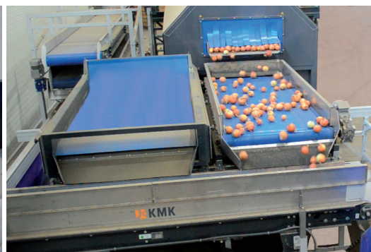
Транспортер by-pass (пересувається вліво-вправо на спільній рамі)
