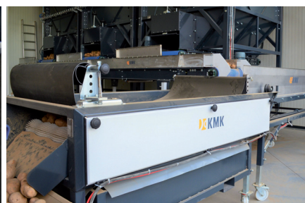
Очисник з ємкістю для сміття і транспортером by-pass
