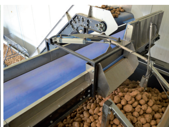
Зміна положення перегородок може здійснюватися оператором із центрального блока управління або за сигналом датчика рівня товару (наприклад в бункерах)
