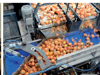
Зміна положення перегородок може здійснюватися оператором із центрального блока управління або за сигналом датчика рівня товару (наприклад в бункерах)
