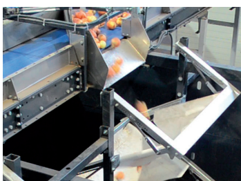
Зміна положення перегородок може здійснюватися оператором із центрального блока управління або за сигналом датчика рівня товару (наприклад в бункерах)
